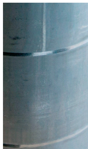
Rys. 4. Zbliżenie grani spoiny czołowej łączącej elementy z tytanu; brak śladów utlenienia
