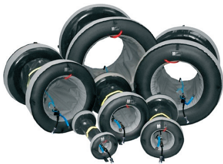
Rys. 1. Rozwiązanie QuickPurge®, zapewniające czystość grani spoiny przy spawaniu rur, składające się z pompowanych przegród połączonych rękawem
